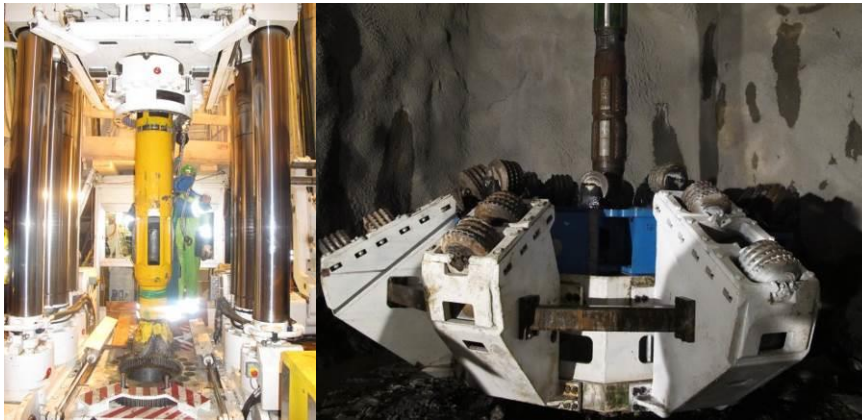
Şekil 11 – Basınçlı Kuyu İçin Raise-Boring (Projejt Maschine 11, PSW Vianden)
