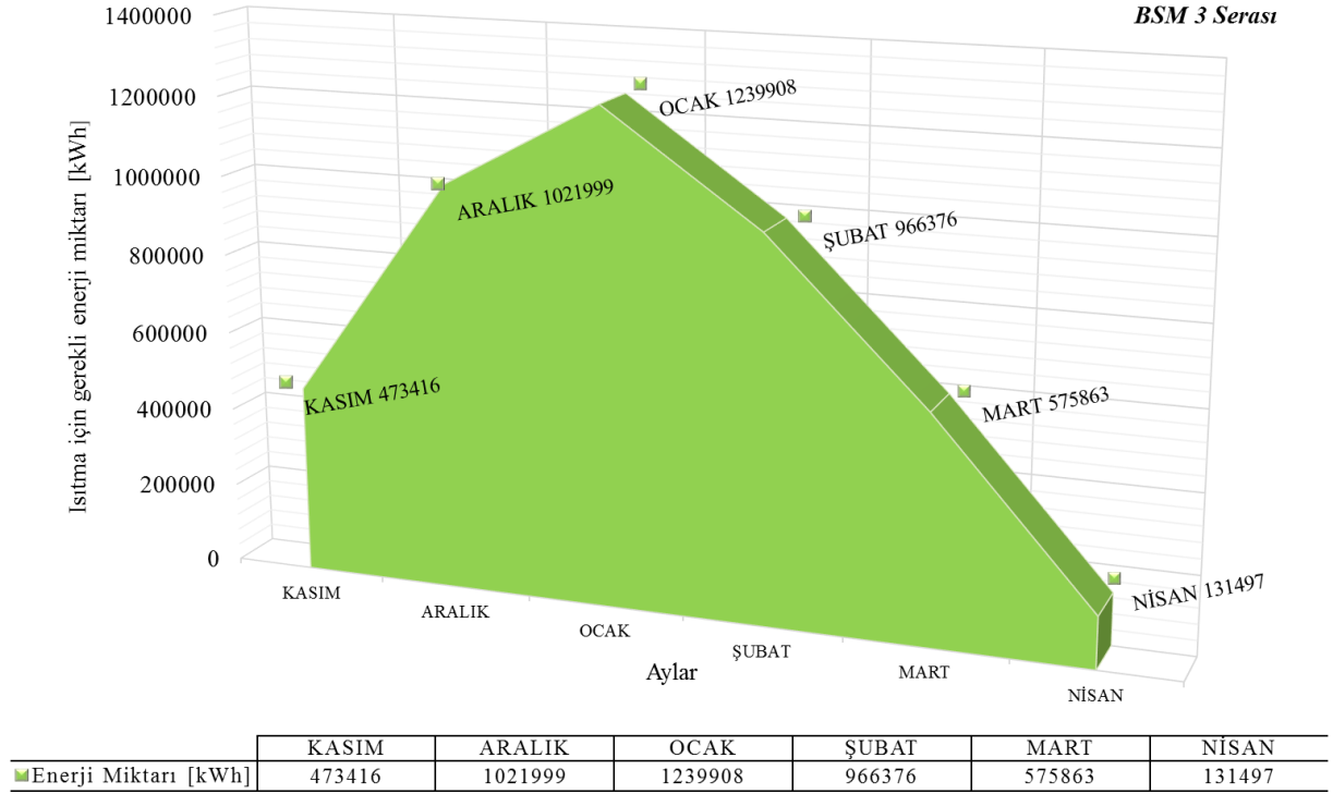
Şekil 3.2.3. BSM 3 serası için aylık ısıtma enerjisi ihtiyacının değişimi
